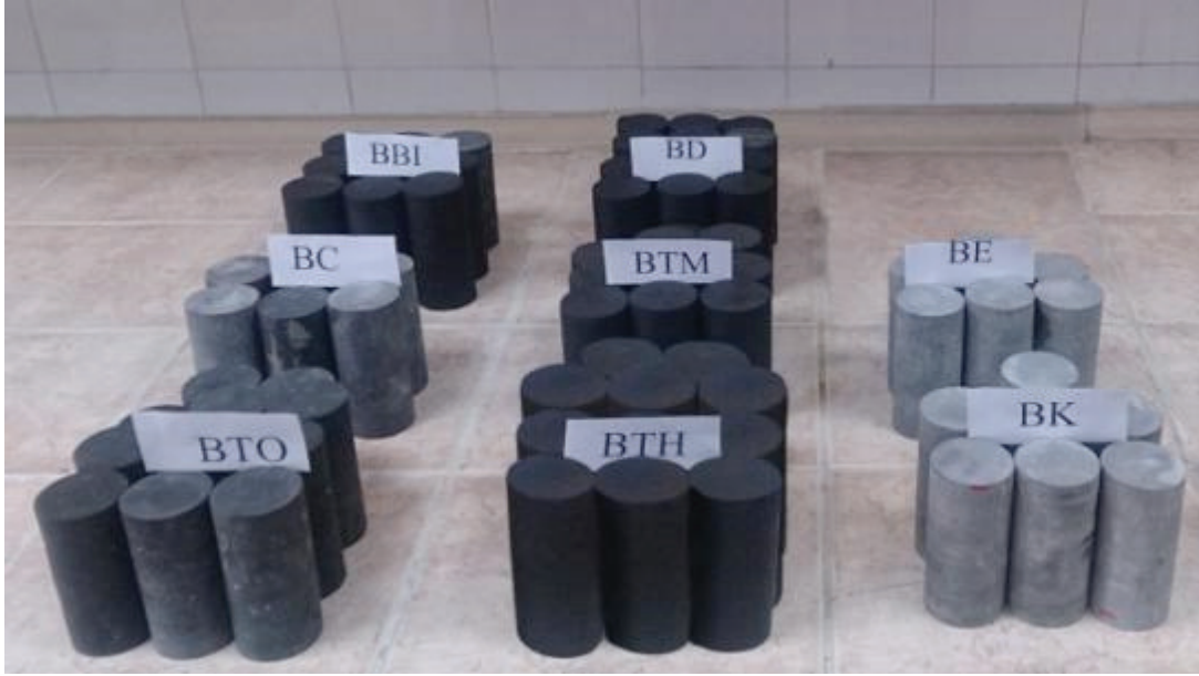
Şekil 2. Laboratuvar çalışmalarında kullanılan bazalt karot örnekleri.
